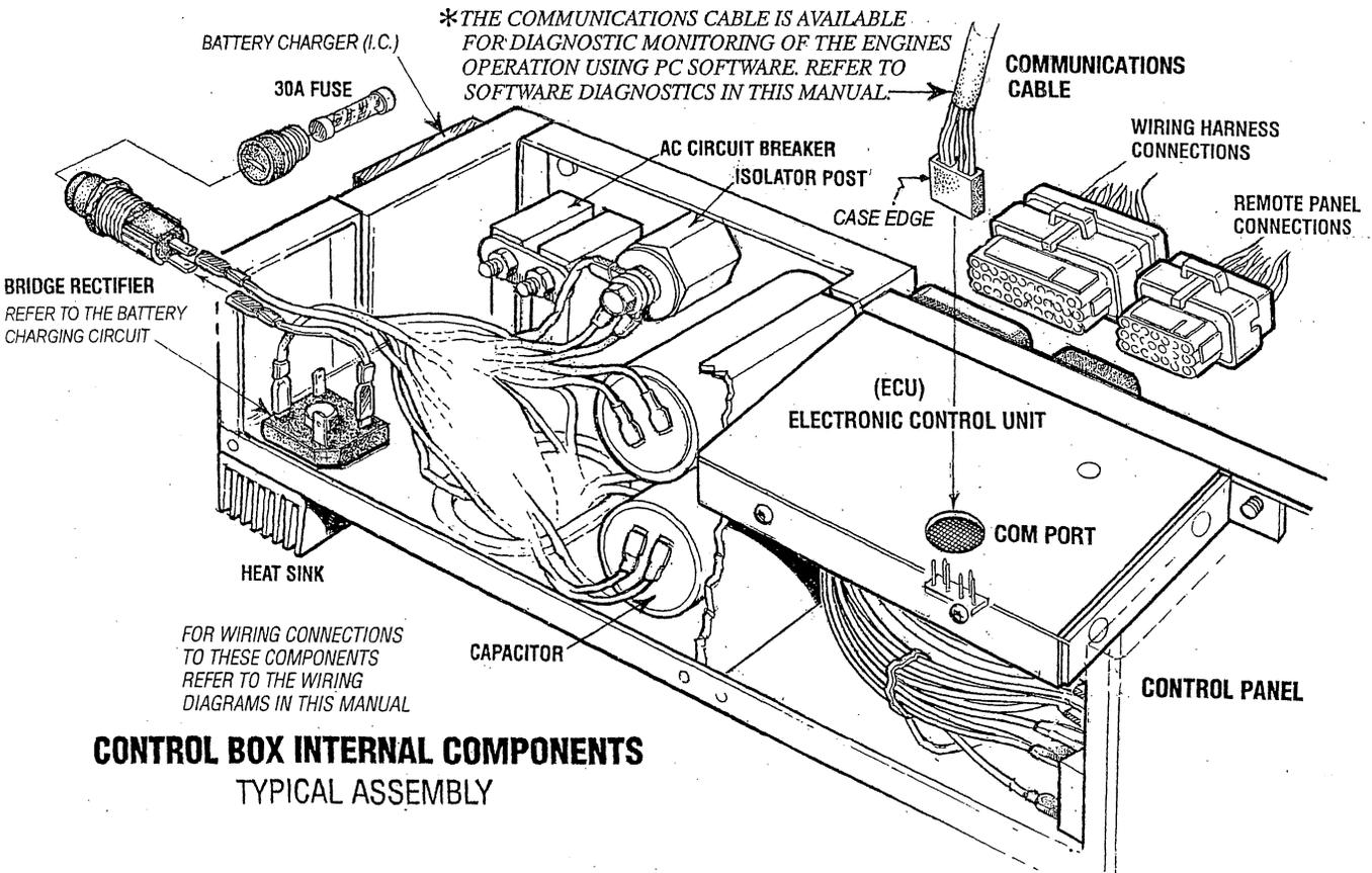
**CONTROL BOX INTERNAL COMPONENTS**
