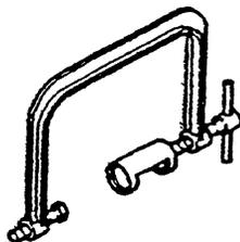
**OIL PUMP OIL SEAL INSTALLER**
