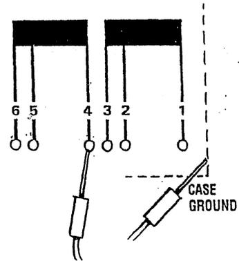
TEST EACH WINDING TO CASE GROUND
