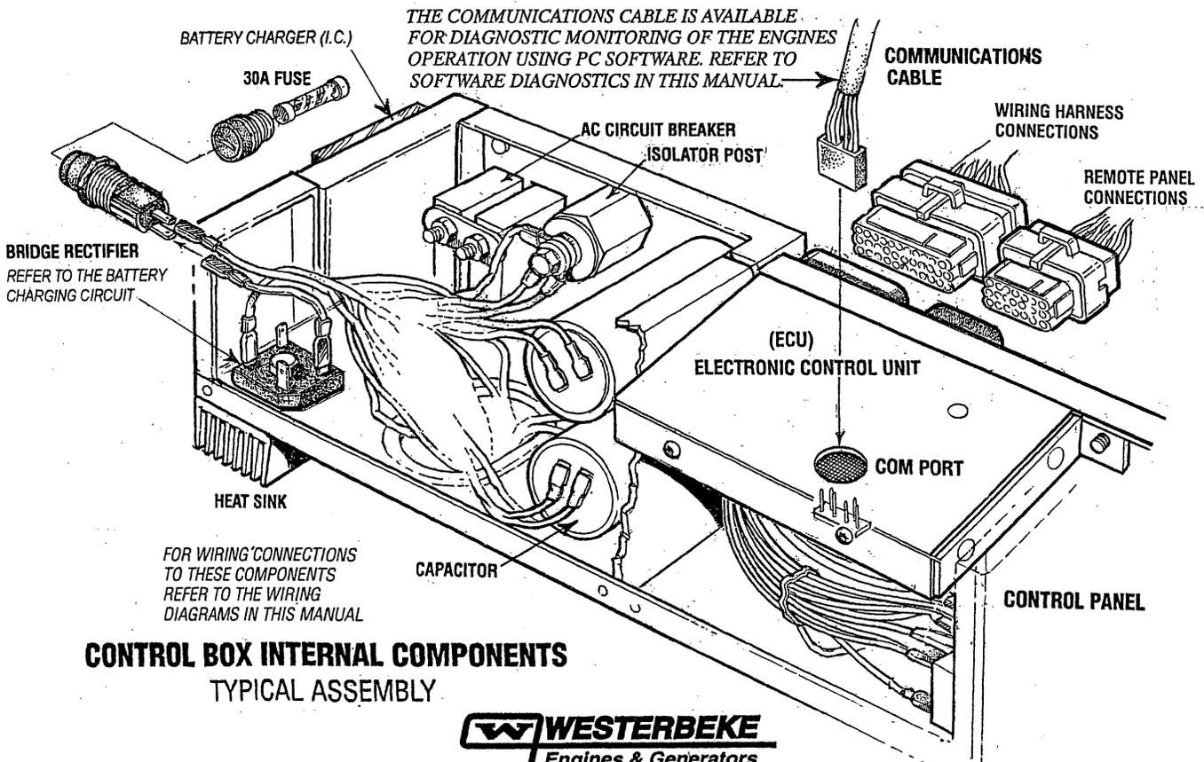
**CONTROL BOX INTERNAL COMPONENTS**
