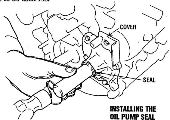
INSTALLING THE OIL PUMP SEAL
